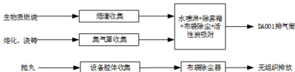
图4-1 废气收集处理流程图
